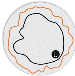
図 6. R760 5GHz エレベーションアンテナパターン
