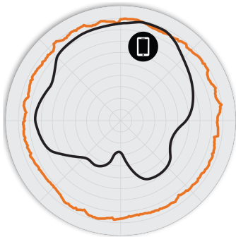
Figura 2. R850 2,4 GHz: patrones de antena en acimut
