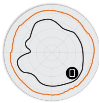
Figura 3. R850 5 GHz: patrones de antena en acimut
