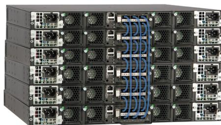
図 4: Ruckus ICX 7750 スイッチは、スイッチあたり最大 12 個の標準全二重 40 Gbps QSFP+ ポートを使って最大 12 基のスイッチをスタックし、最大 5.76 Tbps のアグリゲートスタッキング帯域幅を提供します。
