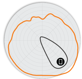
図 5. R650 5GHz エレベーションアンテナ パターン
